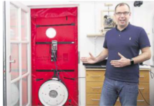
André Heider erklärt eine Blower-Door-Anlage in seinem energetischen Anbau. FOTO: WENZEL
